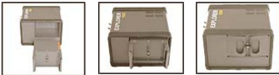
Положите генератор на его большую боковую сторону, как показано на иллюстрации. Расположите батарею так, как показано на иллюстрации, чтобы предохранители находились сверху. Вращая зажим на батарее, освободите ее ручки и приведите их в полностью поднятое положение. Введите батарею в генератор и установите ее, слегка надавив. Опустите ручки батареи и зафиксируйте их при помощи зажима. Поставьте генератор в рабочее положение.
